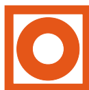
Pulsador de alarma
